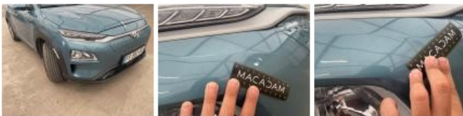
Pare-chocs AV, Déformé / Forcé, LI - Réparer et peindre (complet)
