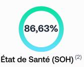
Capacité utile restante / Capacité utile neuve (3)
