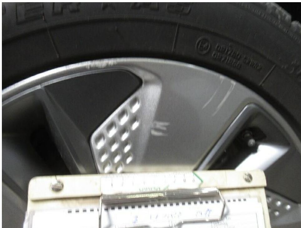
Bild 6 : Felge vorne rechts, zerkratzt, smart repair
