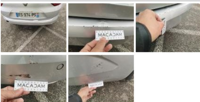
Pare-chocs AR, Déformé / Forcé, Le - Remplacer et peindre
