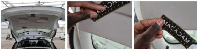
Joint de coffre/hayon, Déchirure, E - Remplacer
