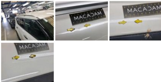
Pare-chocs AR, Fêlure, LI - Réparer et peindre (complet)
