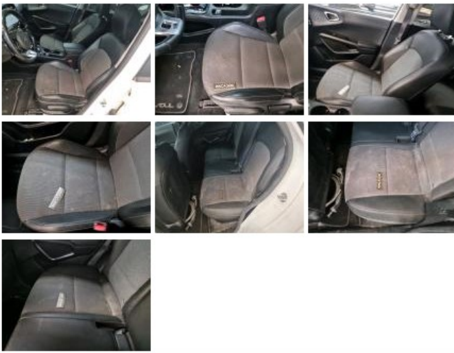
Revêtement assise ARG, Griffe(s), Acceptable
