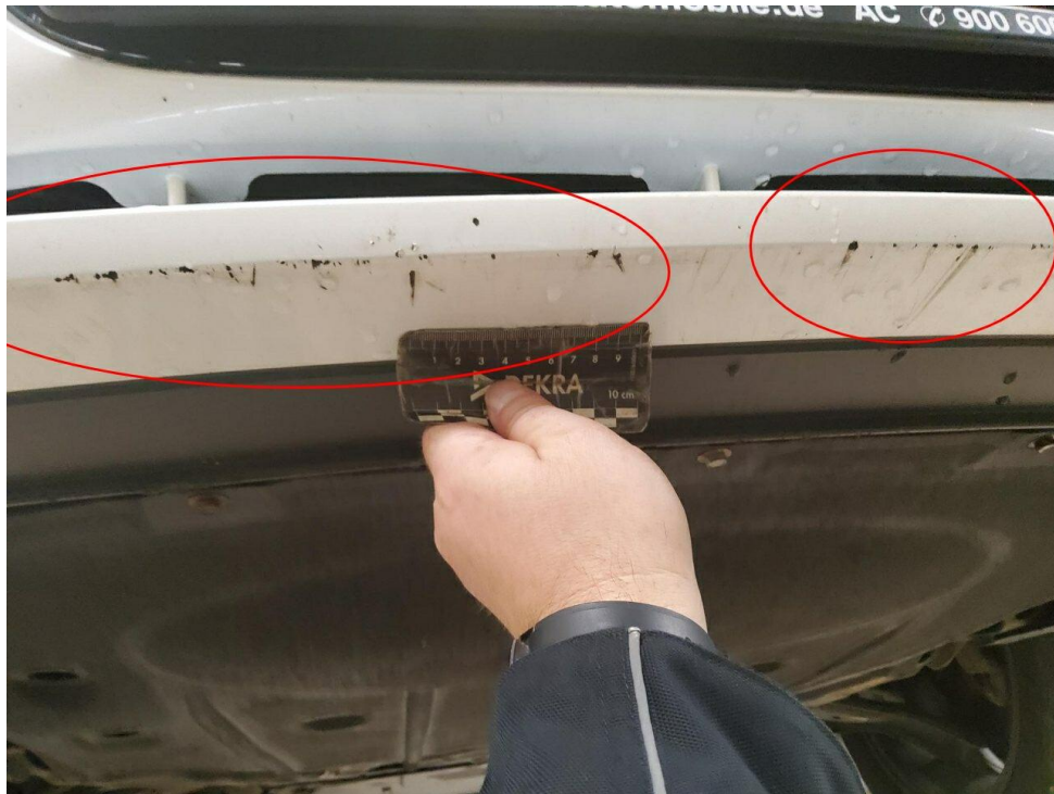
Bild 7 : Stoßfänger vorne Lackierung, verschrammt, smart repair
