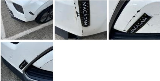
Moulure de pare-chocs AV, Cassé, E - Remplacer
