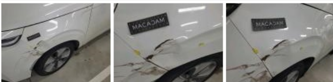
Porte AVG, Bosse(s) et griffe(s), LI - Réparer et peindre (complet)
