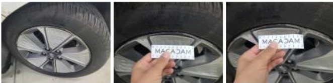
Pneu AVG, Déchirure, E - Remplacer
