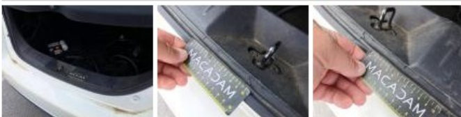
Joint de coffre/hayon, Déchirure, E - Remplacer
