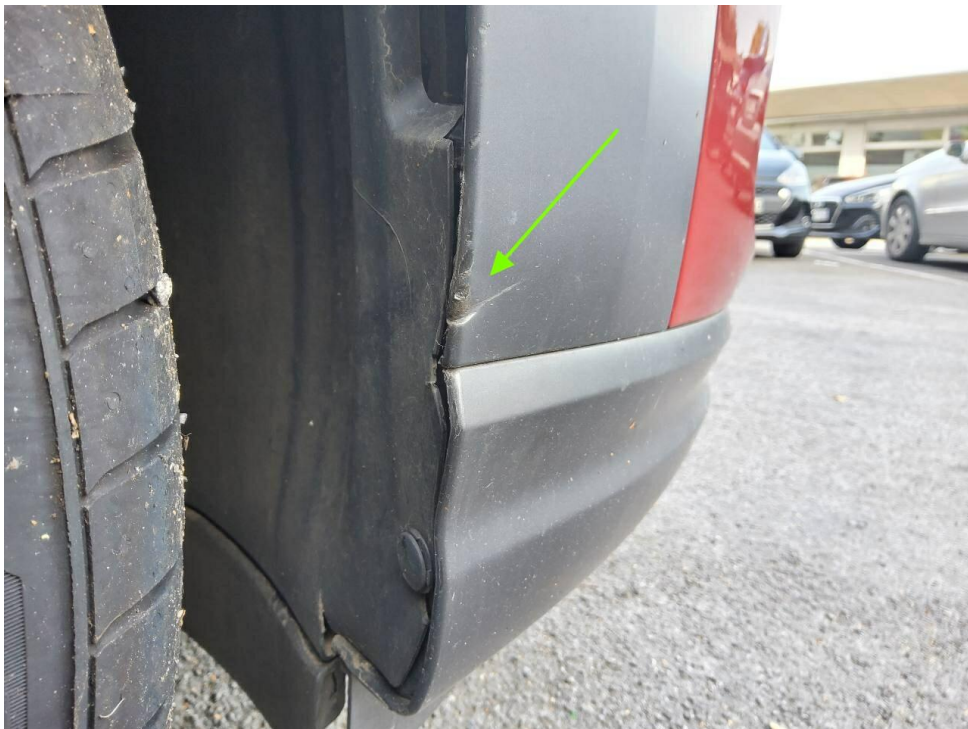
Bild 14 : Stoßfänger vorne, Zierleiste rechts, deformiert
