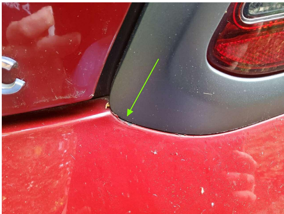
Bild 16 : Stoßfängerverkleidung hinten verschoben, Lackierung gestaucht, Kunststoffteil zerkratzt
