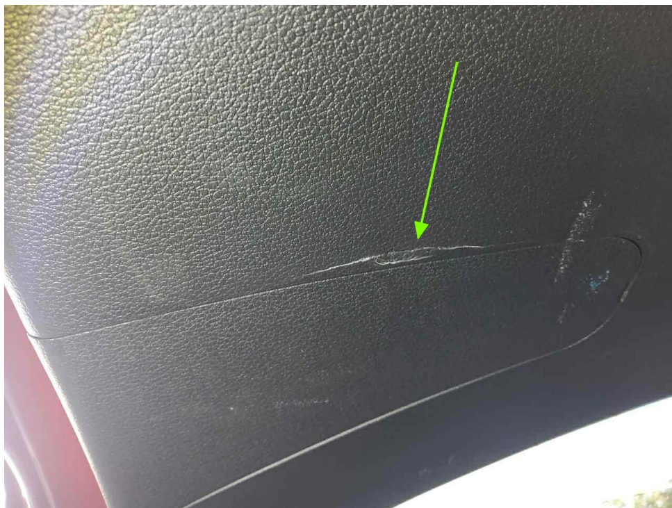
Bild 8 : Kofferraumklappe , verkleidung gebrochen
