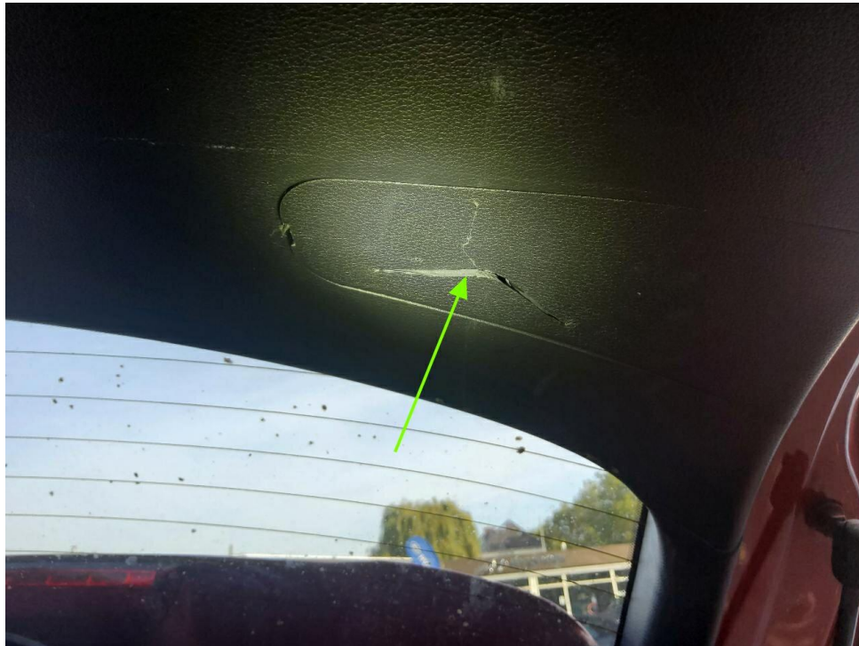
Bild 9 : Kofferraumklappe , verkleidung gebrochen
