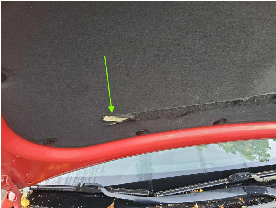
Bild 11 : Tierversbiss im Motorraum
