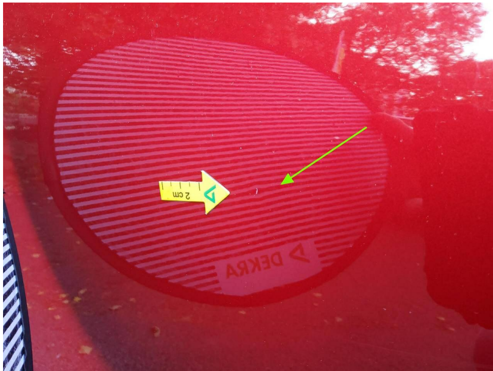
Bild 7 : Tür vorne rechts, eingedellt, drücken
