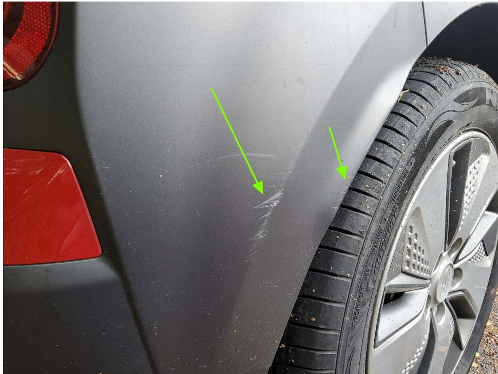
Bild 15 : Stoßfängerverkleidung hinten verschoben, Lackierung gestaucht, Kunststoffteil zerkratzt
